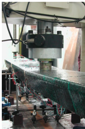
FRP合成桁の曲げ載荷実験
