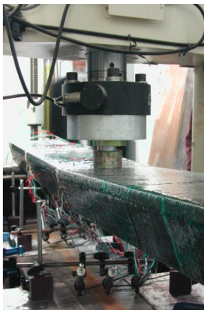
FRP合成桁の曲げ載荷実験
