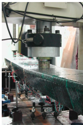
FRP合成桁の曲げ載荷実験
