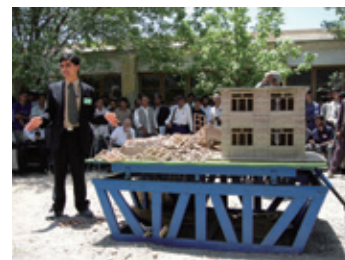
アフガニスタンでの建物模型（耐震補強ありなし）の振動台実演
