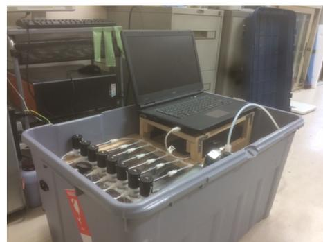
図 1 自動大気捕集装置
